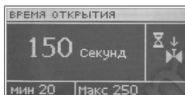
В этой функции настраивается время открытия клапана, то есть, как долго открывается клапан до значения 100%. Это время следует подобрать согласно установленному сервомотору клапана (указан на заводском щитке).
