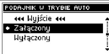
Подаватель можно выключить для ручной подачи топлива или для того, чтобы вызвать погашение котла.
