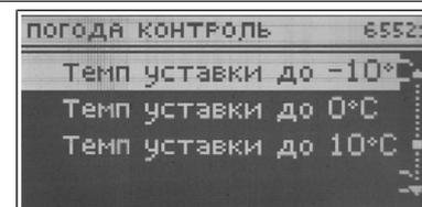
клапана для соответствующих значений наружной температуры. На основании установленных пунктов рассчитываются значения для средних пунктов.
