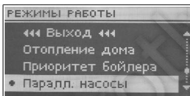
В этом режиме работа насосов начинается параллельно выше предела включения насосов (установленный производителем на 40°C). Насос ц.о. работает все время, а насос гор. воды выключается по достижении заданной температуры на бойлере.
