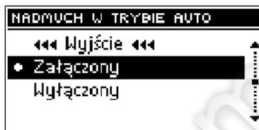
С помощью этой функции можно отключить или включить автоматическую работу вентилятора. Наддув можно отключить для ручной настройки естественной тяги дымохода.
