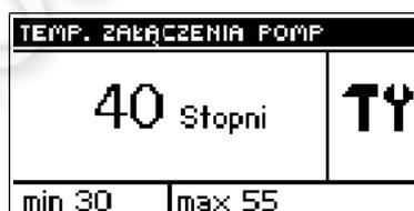
Эта опция используется для настройки температуры включения насосов ЦО и ГВС, температура измеряется в котле. Ниже установленной температуры оба насоса не работают, а выше этой температуры насосы включены и работают в зависимости от режима работы (см. Режим работы насосов).
