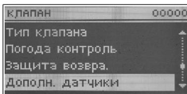
В случае применения двух смешивающих клапанов следует выбрать, будет для считываться измерение для датчика возврата и наружного датчика со второго модуля клапана, или с выхода настраиваемого модуля – собственные датчики).
