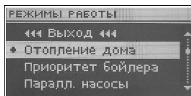
Выбирая эту функцию, регулятор переходит в состояние отопления только дома. Насос ц.о. начинает работать выше предела включения насосов (установленный производителем на 40°C - см. раздел). Ниже этой температуры насос перестает работать (минус 2°C- гистерезис ц.о.).
