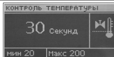
температуры (отклонение от заданной), то электроклапан приоткроется или прикроется на установленный шаг, чтобы достичь заданной температуры.
