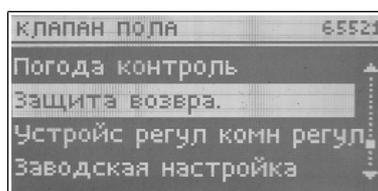
После включения защиты возврата следует настроить максимальную и минимальную температуру возврата для защиты котла. Эта функция позволяет предотвратить вскипание воды в короткой циркуляции котла и защищает от
