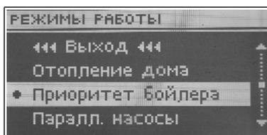
В том режиме включен насос бойлера (гор. воды), до достижения установленной температуры (см. раздел ), по ее достижении насос будет выключен и активируется циркуляционный насос ц.о.
