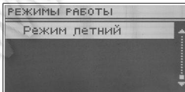
После включения этой функции насос Ц.О. выключается, а насос Г.В.С. включается выше предела включения насосов (заводская настройка на 40°C). В этом режиме насос Г.В.С. работает все время предела включения насосов (заводская настройка на 40°C).
