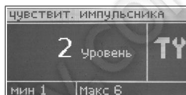
При помощи этой настройки можно изменить чувствительность ручки импульсатора в пределе от 1 до 3 (где 1 - наивысшая чувствительность).
