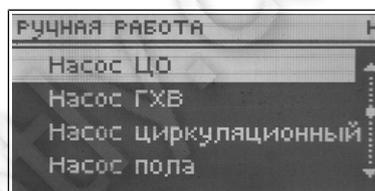
Нажатие импульсатора запускает двигатель выбранного устройства. Это устройство работает до повторного нажатия кнопки ИМПУЛЬСАТОРА.
