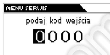
Чтобы войти в функции сервиса контроллера ST-850 следует ввести четырехзначный код. Такой код имеется у производителя котла и компании Tech.
