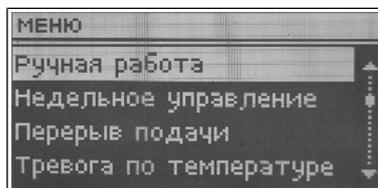
Для удобства пользователя регулятор оснащен модулем ручной работы. В этой функции каждое исполнительное устройство (наддув, насос Ц.О., насос Г.В.С. дополнительный насос - циркуляционный или клапана), включается и выключается независимо от остальных, а каждый активный клапан-смеситель можно закрыть, открыть или остановить.
