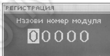
Чтобы зарегистрировать дополнительный клапан, следует вписать серийный номер модуля, управляющего сервомотором смешивающего клапана ST-61 (это пятизначный номер, находящийся на корпусе этого модуля). Без этого номера клапан нельзя активировать.
