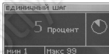
В этой функции устанавливается процентный одинарный шаг открытия клапана, то есть максимальный процент открытия или закрытия, который может за один раз выполнить клапан (максимальное движение клапана в одном измерительном цикле).
