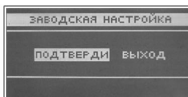
Регулятор предварительно настроен для работы. Однако, его следует привести в соответствие с собственными потребностями. В каждом моменте можно возвратиться к заводским настройкам. Включая функцию заводские настройки, теряются все настройки, установленные пользователем, а появляются настройки, записанные производителем. С этого момента можно заново установить собственные параметры котла.
